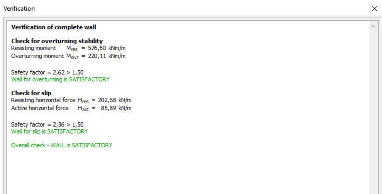
ნახ. 3.1 საყრდენი კედლის შემოწმება ძვრაზე და აყირავებაზე.
