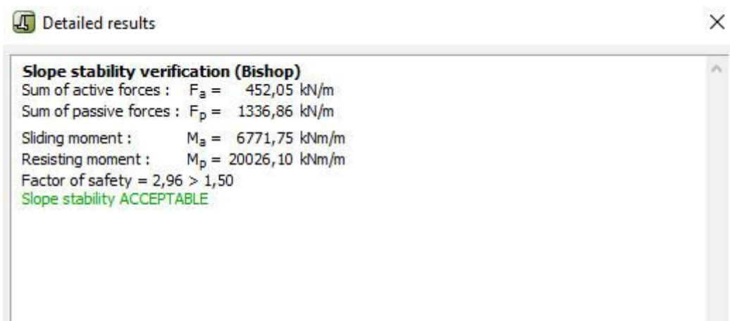
ნახ. 8.1 საყრდენი კედლის მდგრადობაზე გაანგარიშება.
